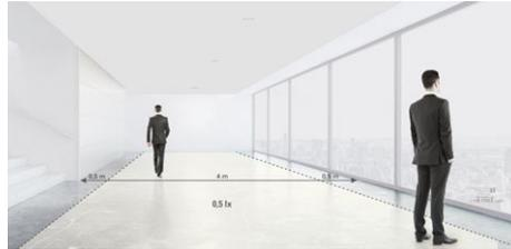
Gemäß DIN EN 1838 können breitere Rettungswege als mehrere 2 m breite Streifen betrachtet oder mit einer flächigen Antipanikbeleuchtung ausgerüstet werden. Wir empfehlen die Ausrüstung mit einer flächigen Antipanikbeleuchtung (0,5 Lux).
