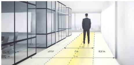
Bei Rettungswegen mit einer Breite von bis zu 2 m muss die Beleuchtungsstärke auf dem Boden entlang der Mittellinie mind. 1 Lux betragen. Der Mittelbereich, der nicht weniger als der Hälfte der Breite entspricht, muss mind. 0,5 Lux betragen.
